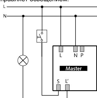
**Параллельная схема Master-Slave**
